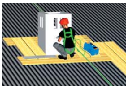
2 Postazione di lavoro resistente alla rottura, ulteriore fune di sicurezza (vedi regola 8)
