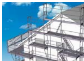
3 Tetto spiovente con ponte da lattoniere e protezione sul lato frontone
