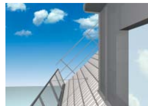
4 Parete di ritenuta sul tetto fissa e protezione lato frontone su tetto esistente
