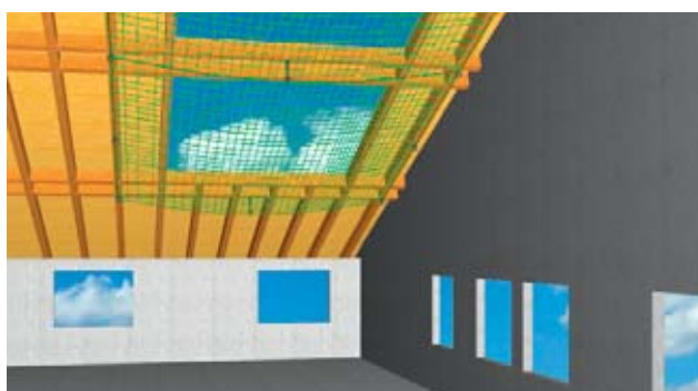
1 Rete di sicurezza provvisoria al di sotto dell'apertura nel tetto
